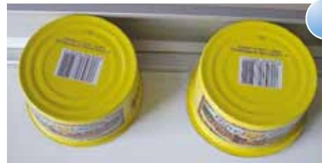
La boîte est généralement fabriquée en deux pièces, **le fond** et **le corps** étant obtenus à partir d'une même feuille (voir photos 1). Le couvercle est fabriqué à part avant d'être serti sur la boîte. Dans certains cas, trois pièces sont nécessaires : le corps est alors une tôle roulée et soudée auquel deux couvercles sont ajoutés.
