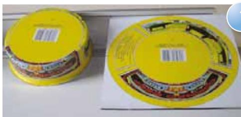
Remarquez que l'impression est faite avant la mise en forme (1 à gauche). Il est donc impératif de pouvoir prédire le mode déformation de la tôle pour pouvoir déformer le motif imprimé qui sera restauré après emboutissage.
