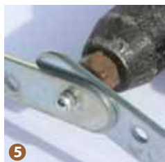
1 Placer le rivet dans le nez de la pince
