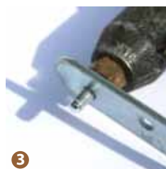
Passer le rivet dans les deux pièces à assembler
