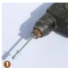
1 Placer le rivet dans le nez de la pince
