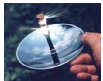
Miroir parabolique (centrales thermosolaires) : concentration des rayons solaires
